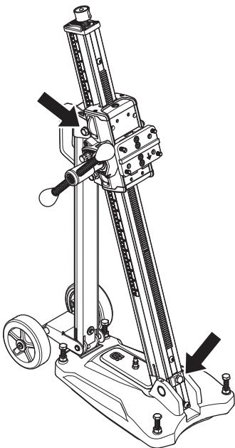
Ослабьте стопорные винты, фиксирующие наклон колонны, и установите угол наклона для бурения. Затяните стопорные винты. Используйте рукоятку подачи. Колонна может отклоняться на угол до 60°.
