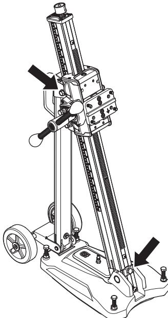
Vabastage samba kallutamiseks lukustuskruvid ja seadistage soovitud puurimisnurk. Keerake lukustuskruvid kinni. Kasutage käepidet. Sammasti saab kallutada 0–60°.
