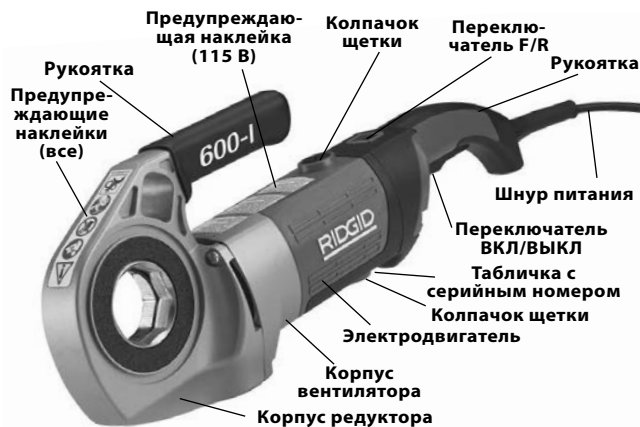
Рис. 1 – Силовой привод модели 600-I
