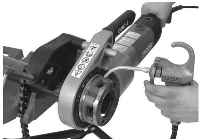
Рис. 14 – Нарезание резьбы на трубе
