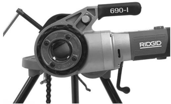
Рис. 12 – Правильное расположение силового привода
