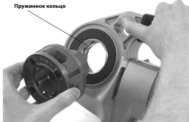
Рис. 9 – Установка резьбонарезных головок в силовой привод 600-I
