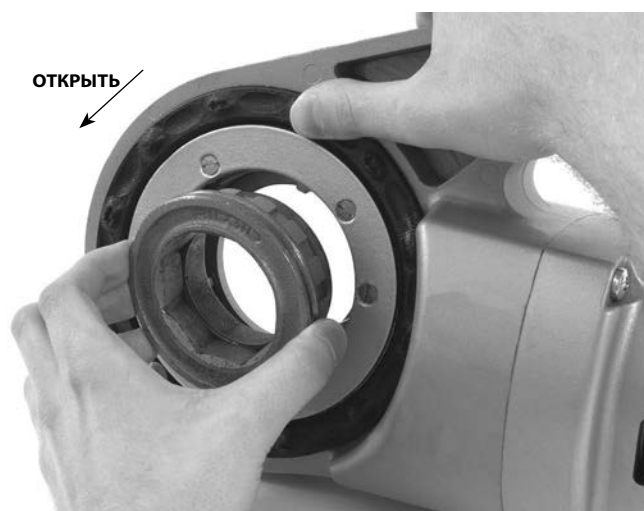
Рис. 8 – Установка переходника в силовой привод 690-I
