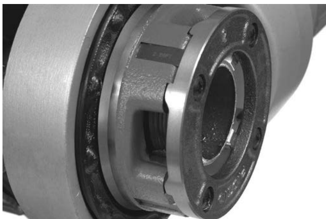
Рис. 15 – Торец трубы вровень с кромкой резьбонарезных гребенок
