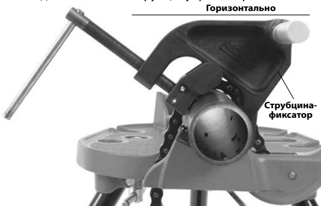
Рис. 11А – Расположение струбцины-фиксатора
